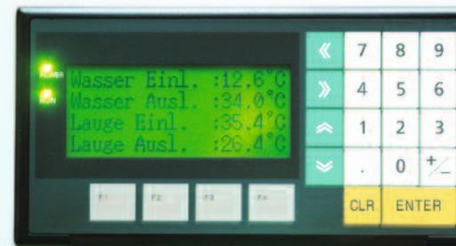
Kontrollanzeige für die Wärmerückgewinnung
